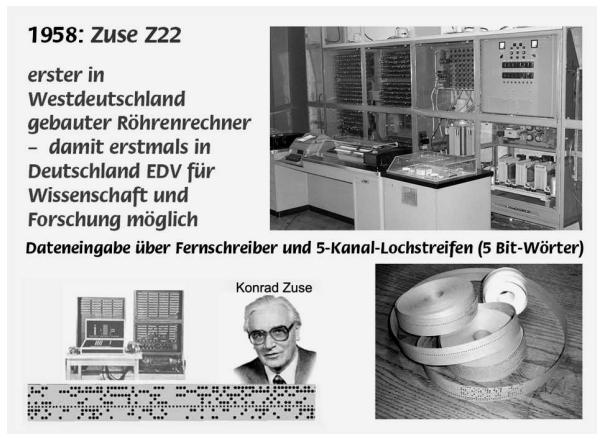
Abbildung 7. Deutscher Röhrenrechner Zuse Z22
